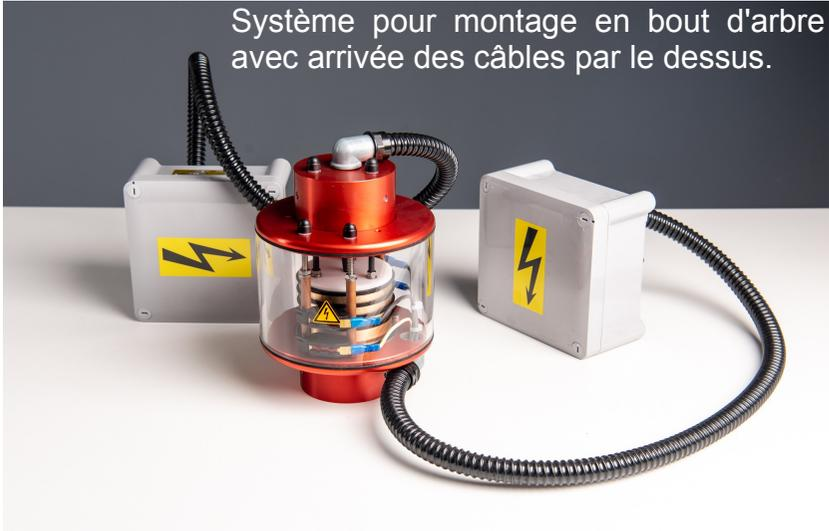
C.E.T Ø500mm pour arbre traversant Ø250mm, 44 pistes + terre, dont 42 bagues pour courants faibles type mesure de température, de courant, de niveau. Raccordement par boîtes de connexion équipées et positionnement des têtes de codeur pour accéléromètre. Collecteur équipant des hydroliennes.
