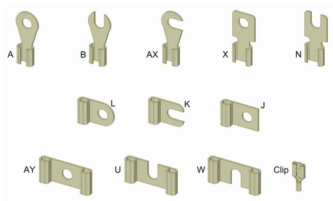
Le diamètre du trou ou de l'encoche de la(des) cosse(s) sera à spécifier sur la fiche d'identification, en fin de brochure, pour éviter tout problème au montage final. Pour les cosses type « clip », il faudra indiquer la largeur de la fiche.
