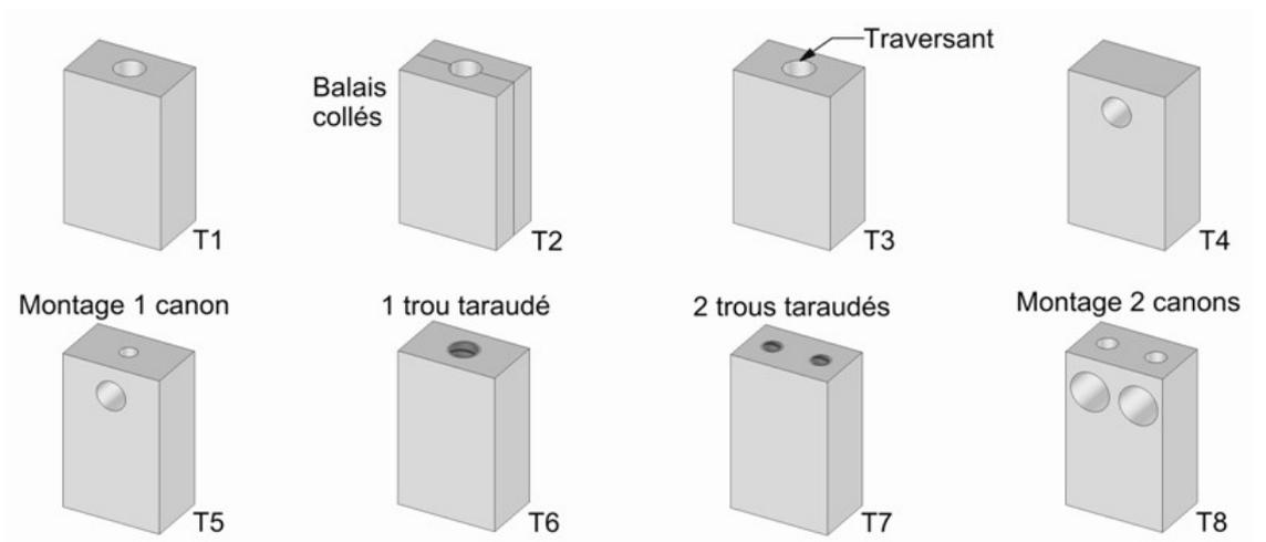
**Positions du(des) câble(s) sur le(s) bloc(s)**
